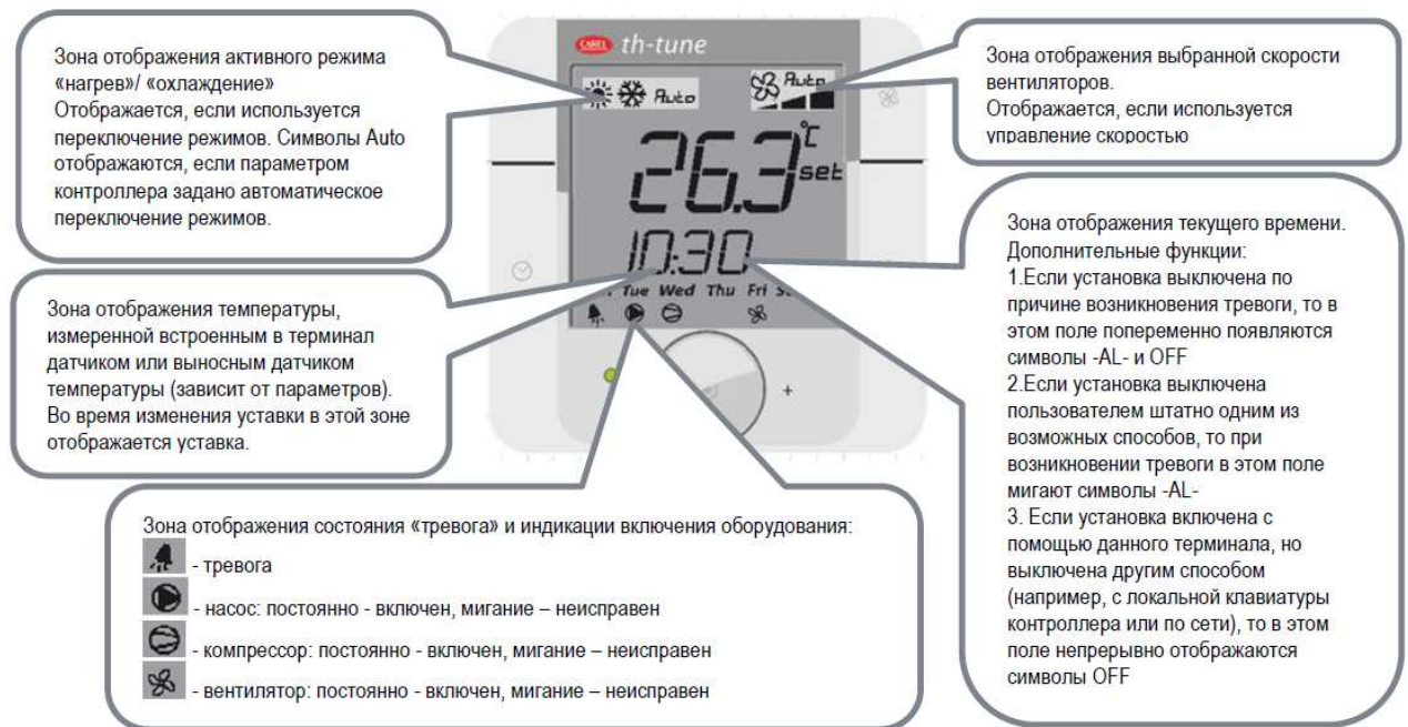
Рис.13.- Внешний вид и описание дисплея терминала th-Tune.
