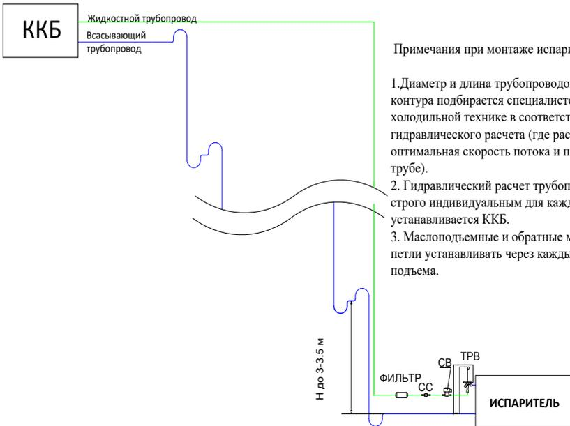
Примечания при монтаже испарителя НИЖЕ ККБ:
