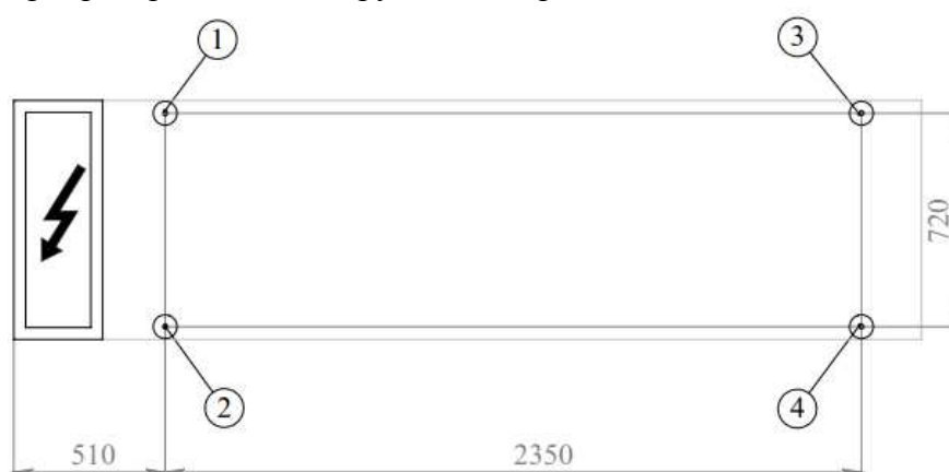
Рис. 4.3.7 Монтаж опор и распределение нагрузки чиллера 360
