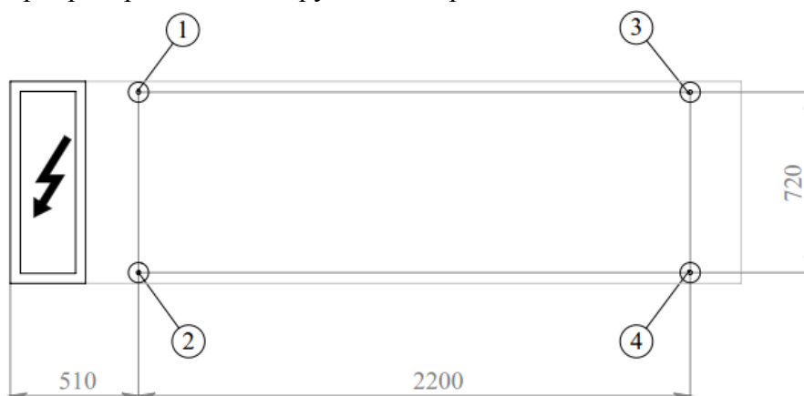
Рис. 4.3.6 Монтаж опор и распределение нагрузки чиллера 300
