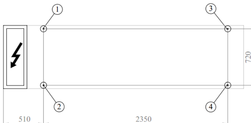
Рис. 4.3.7 Монтаж опор и распределение нагрузки чиллера 360
