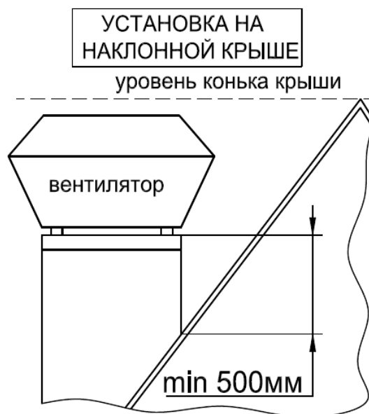
Рисунок 5.2 – Монтаж на наклонной кровле
