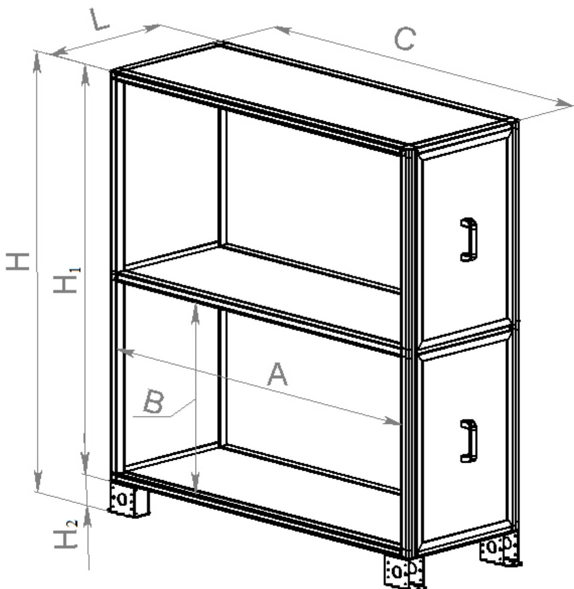
**Примечание:** В состоянии поставки секции имеют отличные от табличных размеров габариты за счет установки на секции транспортировочных брусков и монтажа коммутационных элементов на штатные места (гибкие вставки и заслонки).
