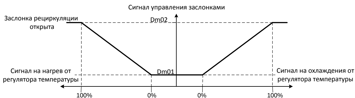
Рис.18.- Алгоритм работы заслонки рециркуляции в последовательности охлаждения и нагрева
