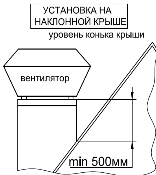
Рисунок 5.2 – Монтаж на наклонной кровле
